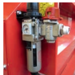
Afsluitklep voor perslucht (Alleen voor lucht modellen)
